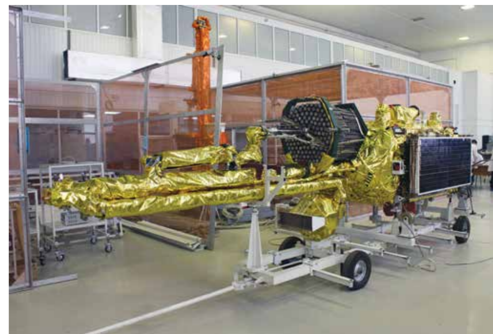
Радиолокатор ДЗЗ «Стриж» в пусковом положении на платформе КА «Кондор-Э» ↓
